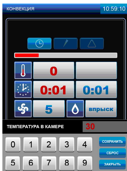
Рис.13.Редактирование параметра « ТЕМПЕРАТУРА В КАМЕРЕ »
